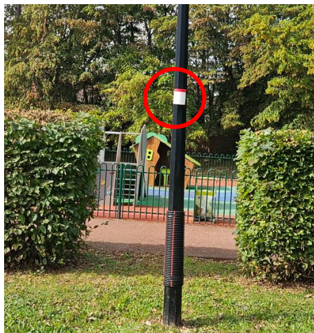
Tube à diffusion sur site dans un abri cylindrique de protection
