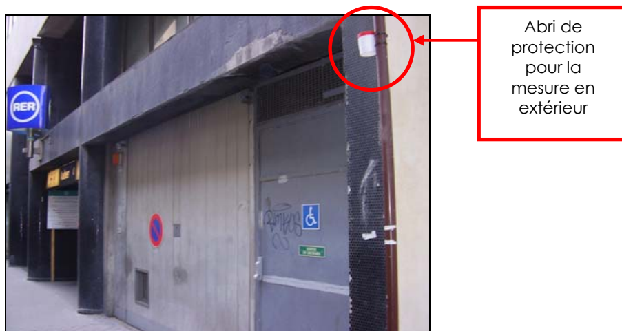
Figure 4 : Illustration du moyen de mesure passive dans son abri de protection sur un site de mesure extérieur rue des Mathurins.
