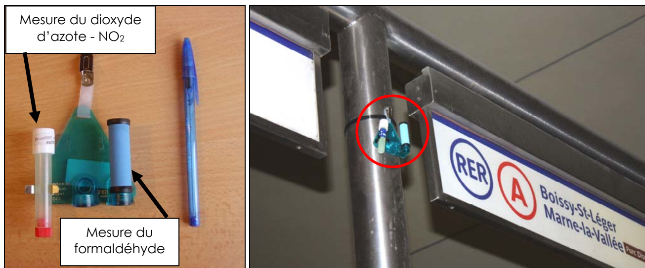
Figure 3 : Illustration des moyens de mesure passive d'un site de mesure au sein de la salle d'échange de la gare RER d'Auber où le NO 2 et le formaldéhyde sont mesurés.
