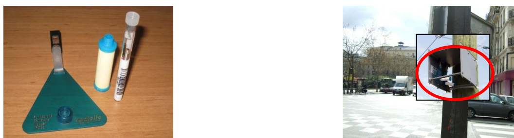
Figure 21 : Schéma d'implantation des tubes à diffusion passive de benzène C_6H_6 au sein de l'abri de protection
