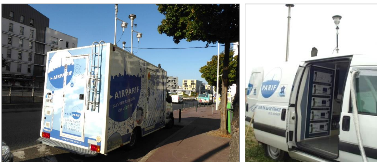
Figure 19 : Laboratoire de mesure et exemple d'un laboratoire de mesure accueillant des analyseurs permettant les mesures horaires de la qualité de l'air de manière automatique
