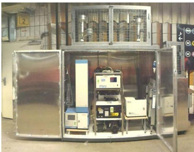
Les concentrations en particules (PM<sub>10</sub>)<sup>7</sup> et particules fines (PM<sub>2,5</sub>) ont été mesurées par analyseurs automatiques, ainsi que les NO<sub>x</sub> sur le site de Saint-Michel-Notre-Dame.
