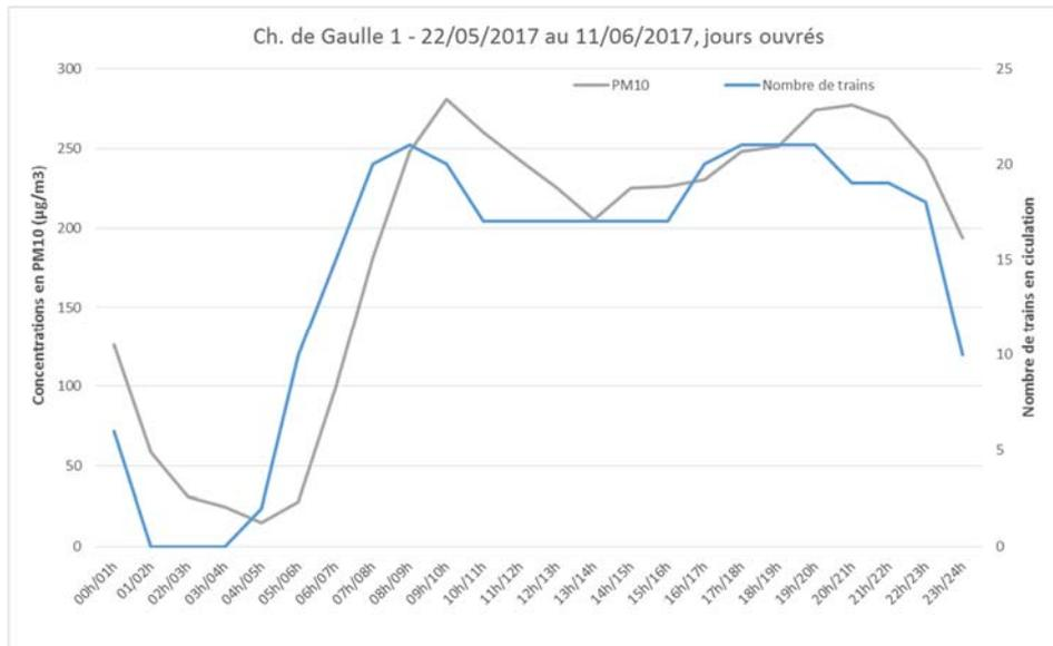
Figure 24 – Croisement entre les teneurs horaires en particules PM<sub>10</sub> observés les jours ouvrés et le nombre de trains en circulation à la gare RER B de CDG1, période du 22/05/2017 au 11/06/2017.
